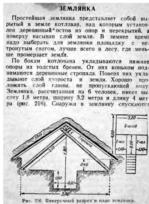
Abb. 18: Sowjetische Schemazeichnung zum Bau einer Semljanka [Anm. 2]
